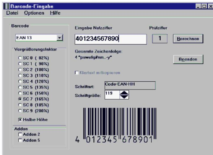
Durch die Verwendung von TrueType-Schriften können in nahezu allen Windows-Anwendungen Barcodes erzeugt und gedruckt werden. Alle Schriften werden auch im Postscript-Format mitgeliefert. Der Barcode kann, im Rahmen der Spezifikationen, frei skaliert und am Bildschirm exakt positioniert werden.
